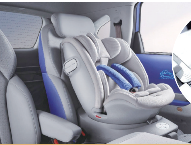
《母婴友好型汽车》团体标准规定,为了保证婴幼儿乘坐的安全,母婴友好型汽车的第二排应当具备机动车儿童约束系统(CRS),应符合欧盟儿童座椅安全标准UN Regulation No.129的要求。图片来源于网络
