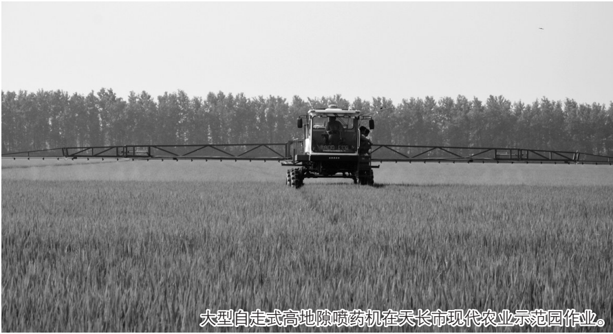
大型自走式高地隙喷药机在天柱市现代农业示范园作业。
