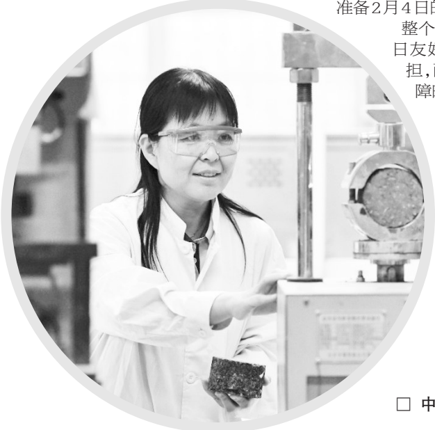
柳浩在进行混合料试件马歇尔稳定度试验。
