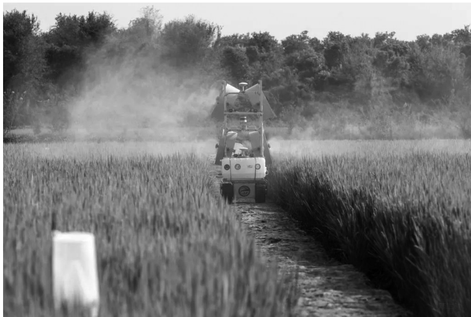
在上海土是宝数字农场,智能变量喷雾机器人利用中国移动5G+北斗高精度定位,实现精准规划的农机作业范围。
