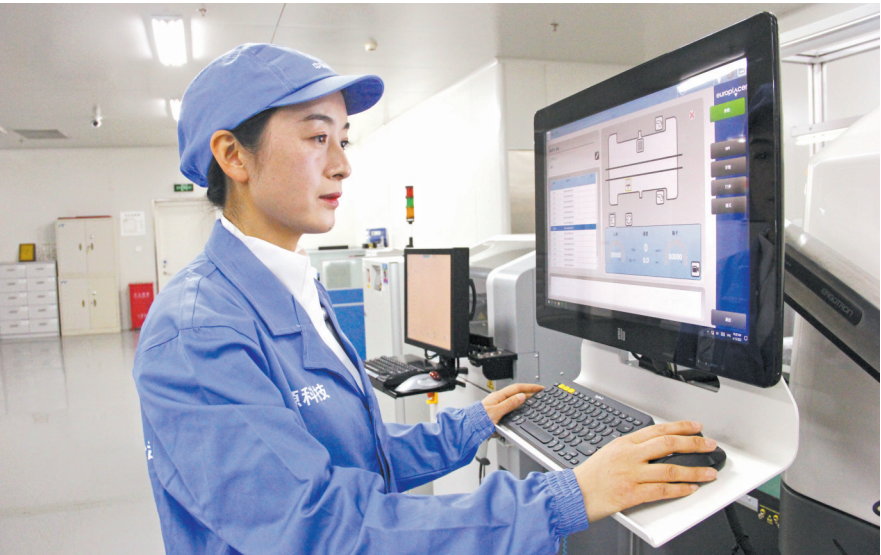
刘芳在操作全自动贴片机。全自动贴片机是用于表面贴装器件的自动贴装,贴装速度高、换线灵活。受访者供图
