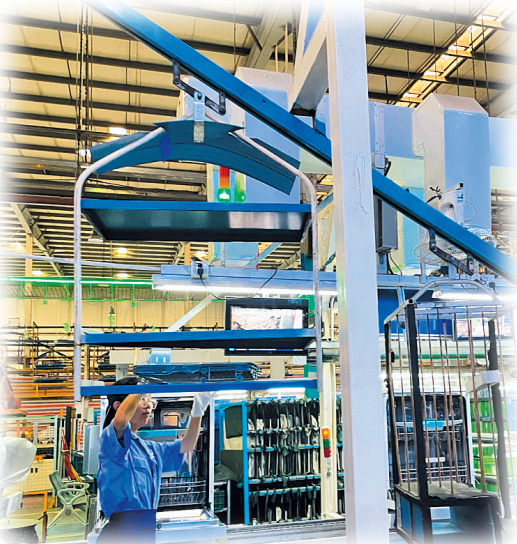
美的厨热洗碗机顺德工厂内工人利用轨道运输作业。
