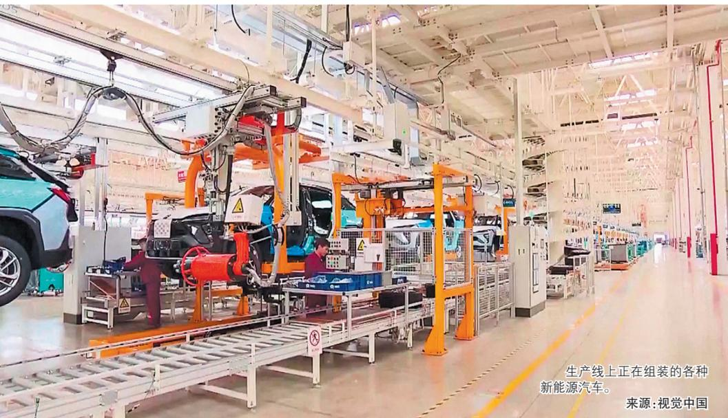
生产线上正在组装的各种新能源汽车。
